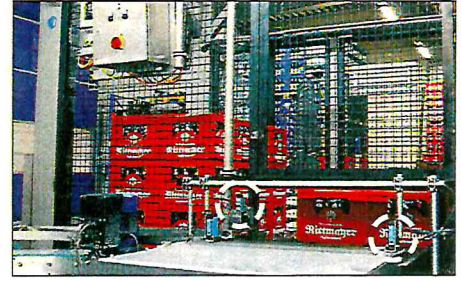
RFID im Getränkekasten – ausgewählte Lesestellen: Tor zur Erfassung von Leergut-Anlieferungen (Bild links), Pfandwertermittlung (Bild Mitte) und Palettierung von Vollgut
