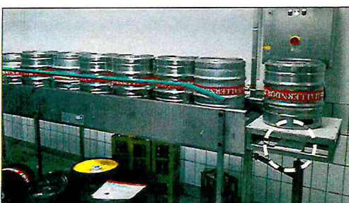
RFID am Bierfass: ausgewählte Lesestellen in der Fassabfüllung
