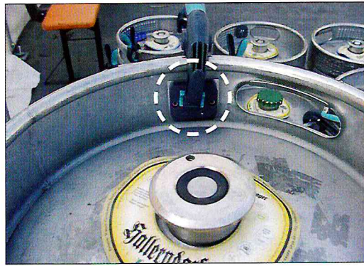
RFID am Bierfass: Aufkleben der Transponder
