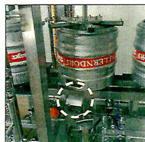
RFID am Bierfass: ausgewählte Lesestellen in der Fassabfüllung
