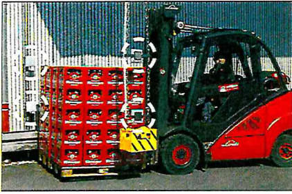
RFID im Getränkekasten – ausgewählte Lesestellen: Tor zur Erfassung von Leergut-Anlieferungen (Bild links), Pfandwertermittlung (Bild Mitte) und Palettierung von Vollgut
